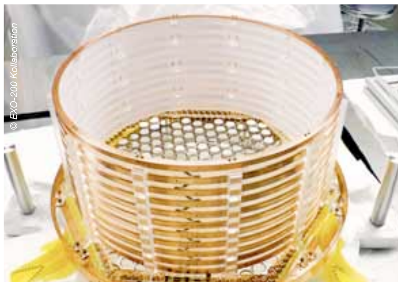
Eine Hälfte der Zeitprojektionskammer vor dem Einbau in den Xenon-Behälter.
